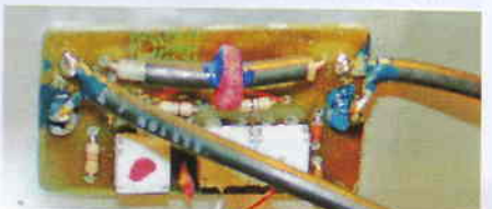
Der Richtkoppler, den Hans Diebold in allen Endstufen verwendet.
