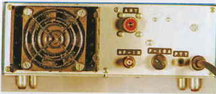
Die 250-Watt-PA von hinten: Nicht nur das Gehäuse, auch Lüfter und Kühlkörper sind kleiner als bei der 400-Watt-Version.
